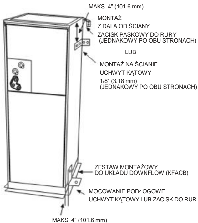
Rys. 7 – Montaż w domu mobilnym
